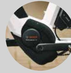
**Corazón eléctrico:** El de esta Bergamont es de primer nivel. Motor Bosch Performance Line Cruise de tercera generación, con ubicación central, y 250W. La batería, enclaustrada en el cuadro, es una Bosch PowerPack de 500Wh. ¡Perfecto para llevaros a ti y a tu carga!
