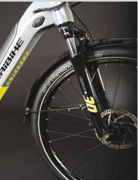
**Campera:** La comodidad y el equipamiento no están reñidos en con cierto espíritu aventurero. La Trekking 6 tiene suspensión delantera con horquilla SR Suntour NEX y 63 milímetros de recorrido o neumáticos Continental Contact Cruiser de 26.5 pulgadas y anchura de 2,4', concebidos. Y, por supuesto, la posibilidad de aprovechar el portaequipajes trasero para sumarle un buen par de alforjas a nuestro viaje.
