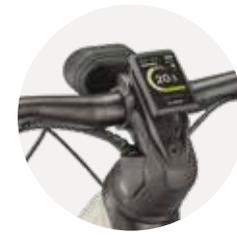
**Tecnológica:** y La Axis incorpora pantalla Bosch Kiox 30. Integrada en el manillar, puede desmontarse y ofrece conectividad Bluetooth compatible con Android e iOS,
