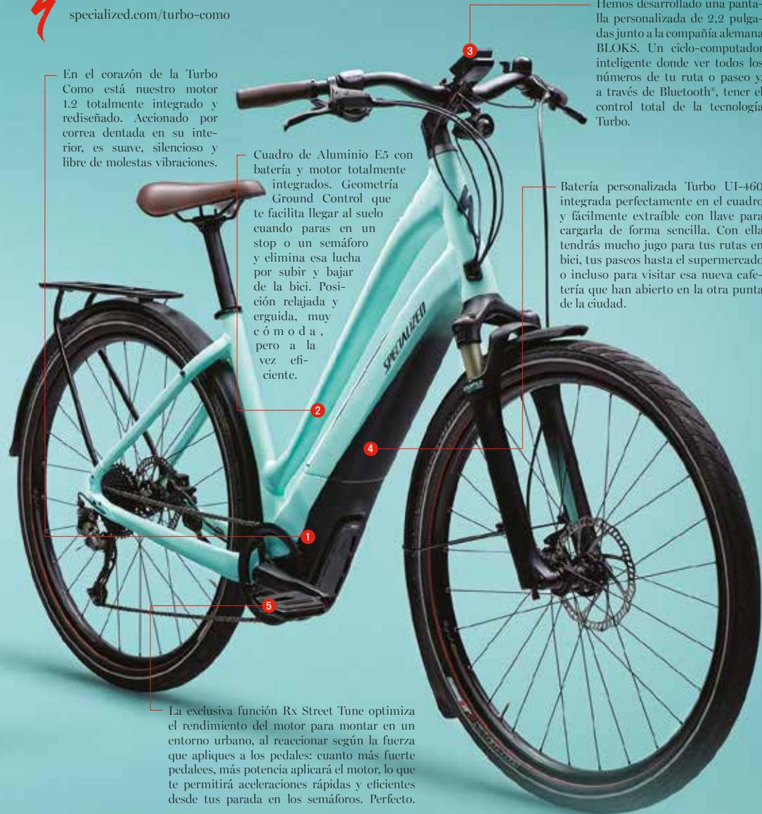
La exclusiva función Rx Street Tune optimiza el rendimiento del motor para montar en un entorno urbano, al reaccionar según la fuerza que apliques a los pedales: cuanto más fuerte pedalees, más potencia aplicará el motor, lo que te permitirá aceleraciones rápidas y eficientes desde tus paradas en los semáforos. Perfecto.
